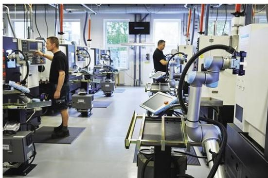
機械加工 - デンマークにある Trelleborg Sealing Solutions 社は、この2年程で42台のUR(ユニバーサルロボット)社製のコボットを持つようになりました。Trelleborg 社ではコボットを導入することで、1人の作業者が稼働中の8台のCNCマシンでセルを管理できるようになっています。
